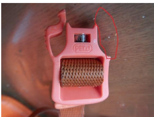
(注1) 2019.2.5 右上部分の爪が破損欠落した状態
